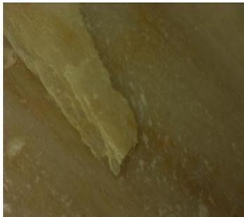
Litotipo olocristallino caratterizzato da una costante laminazione micrometrica ad andamento sinuoso su scala microscopica all'interno delle quali lamine si riconoscono, localmente, bordi di celle organiche ben definite e con modello regolare che ci permettono di riconoscere il materiale quale legno fossile mineralizzato.
